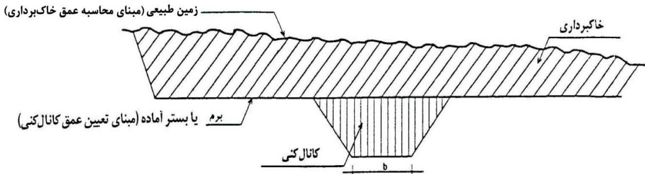
شکل ۱-۳. مقطع عرضی کanal یا زهکش در خاکبرداری کامل (Full Cut)
